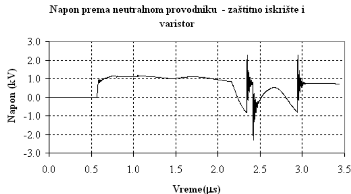
SLIKA 4: NAPON NA POTROŠAČU KADA SE KORISTI SPD TIP 1 (SA ISKRIŠTEM) U MRO I SPD TIP 2 (VARISTOR) 2 M ISPRED POTROŠAČA
